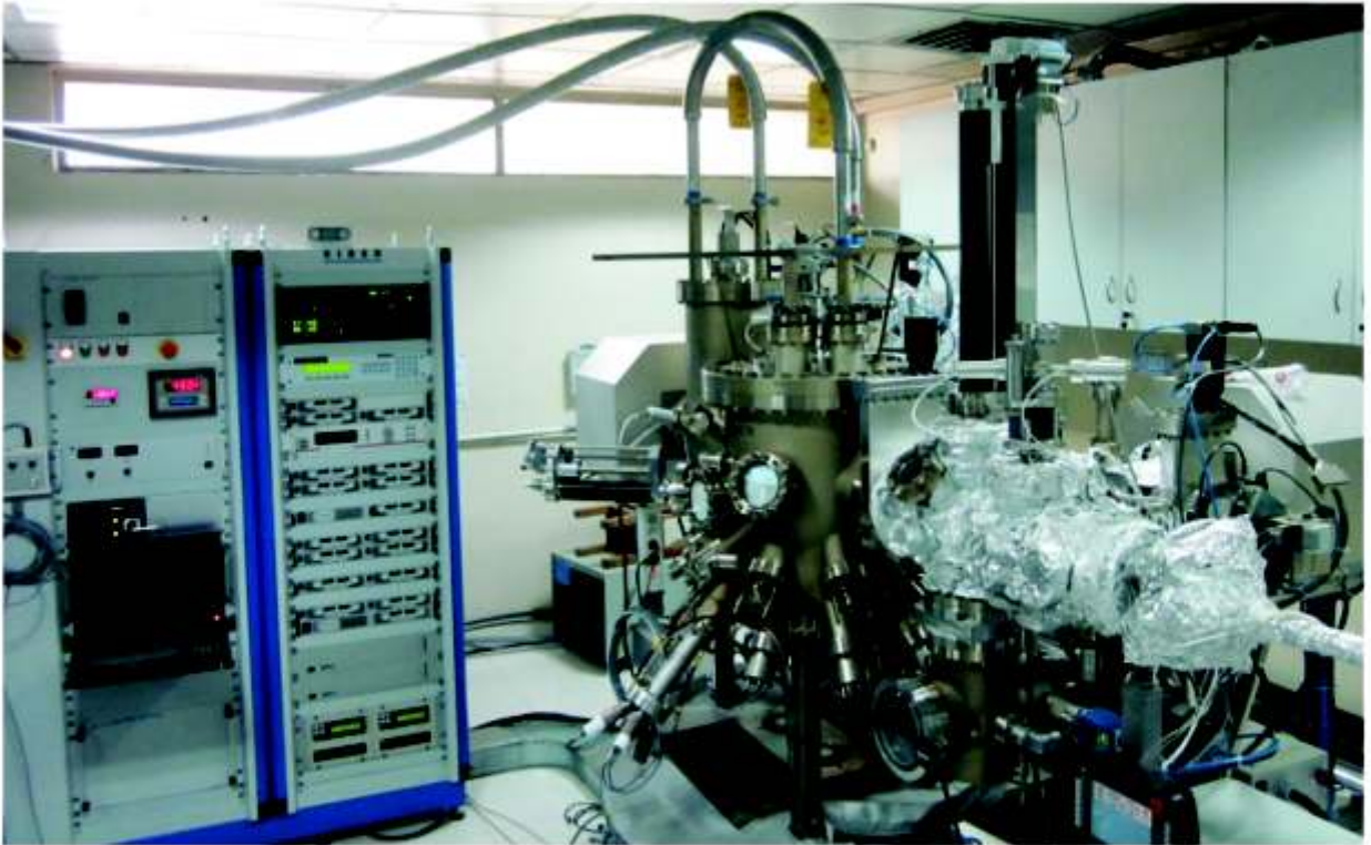
चित्र 1 - तीन कक्षीय नाइट्राइड आर.एफ.प्लाज्मा-आण्विक बीम ऐपीटेक्सी मशीन (3 इंच सबस्ट्रेट)
