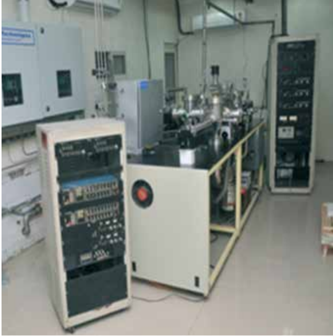
चित्र 2 : अक्रिस्टली तथा माइक्रो/ नैनो क्रिस्टली सिलिकॉन की p-i-n परतों (10 - 10 cm 2 क्षेत्र) के निक्षेपण हेतु बहु-कक्षीय PECVD यन्त्र।
