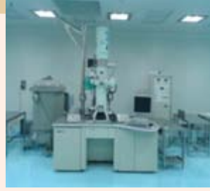
उच्च विभेदन संचरण इलेक्ट्रॉन माइक्रोस्कोप (मेक : JEOL: JEM - 2100F)
