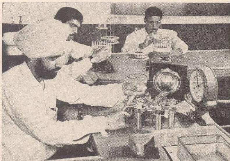
Fig. 17. Centrifuge for Shake-Down Test.
