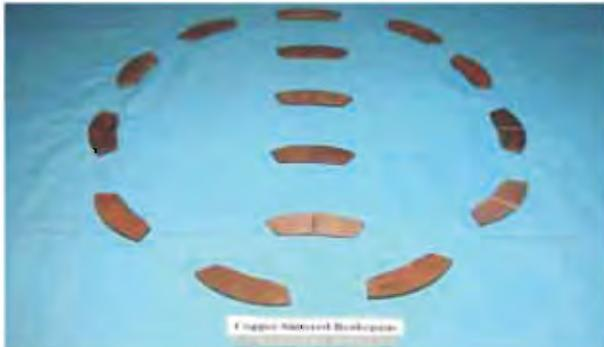
Fig. 3.2 : Copper sintered brakepads
